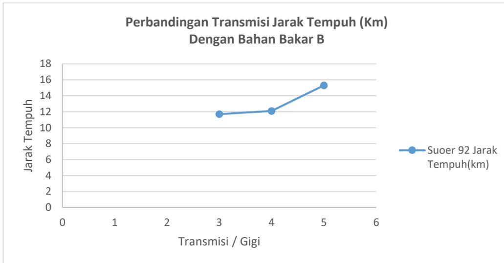
**Grafik 2. Perbandingan Transmisi, Jarak Tempuh pada Gasoline Type B**
