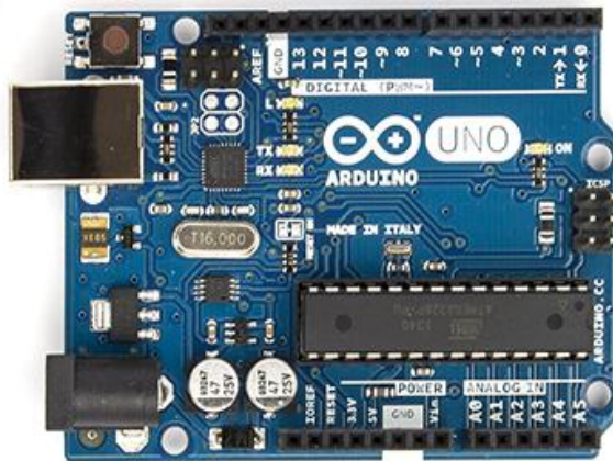
Gambar 1. Modul Mikrokontroler Arduino Uno Sumber : http://arduino.cc/Main/arduinoBoardUno.com
