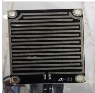
Gambar 4. Penampang Sensor Hujan Sumber ://Dokumentasi Pribadi
