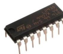
Gambar 2.4 Bentuk Fisik IC L293D Sebagai Driver Motor DC
