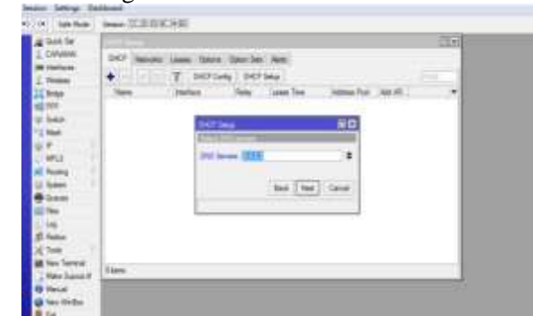
Sumber: Dokumen Pribadi Penulis Gambar 4. Konfigurasi DHCP Server
