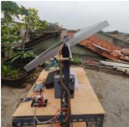
Gambar 9. Pengukuran Tegangan dan Arus tanpa tracking dengan sudut 30°
