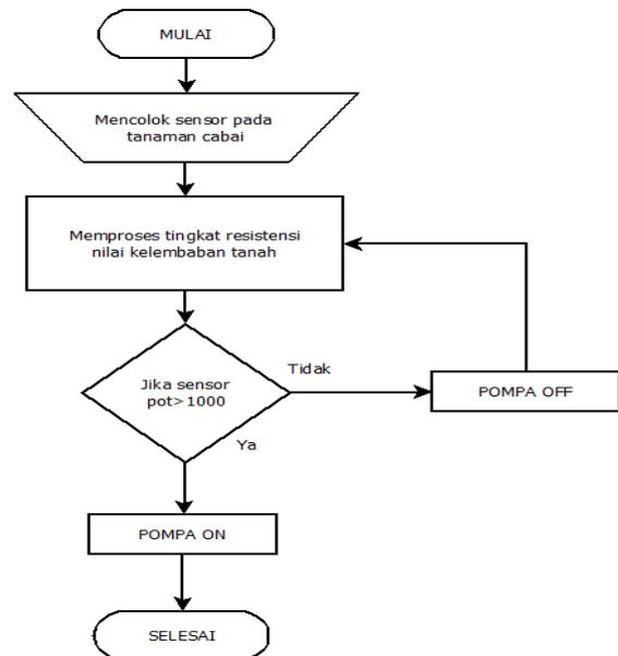
Gambar 5. Flowchart penyiraman tanah
