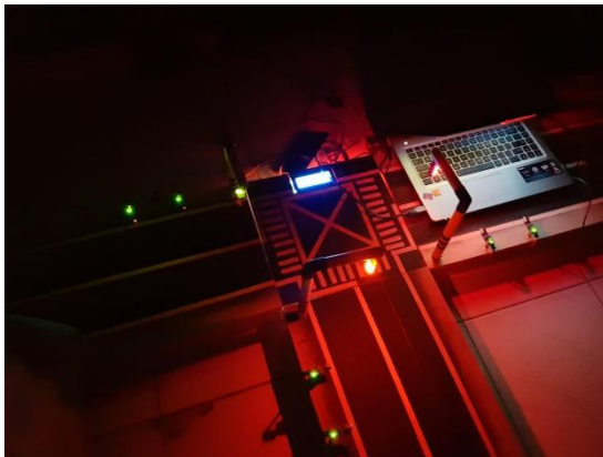
Gambar 7. Maket lampu lalu lintas pada persimpangan menggunakan FTC dan ATC
