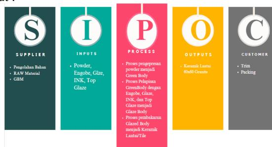
Gambar 3.2. Diagram SIPOC Proses Produksi.
