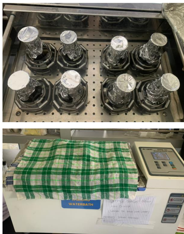
Gambar 2. Fermentasi dalam shaking water bath pada suhu 30 °C selama 96 jam.
