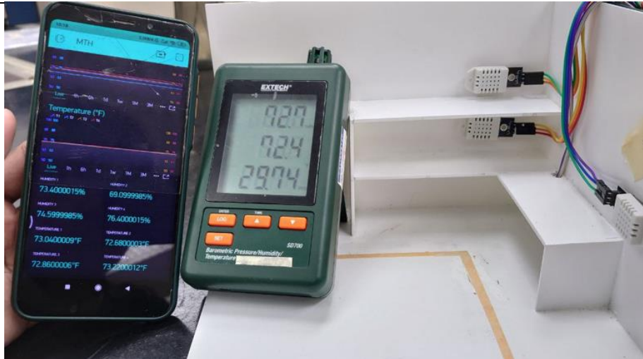
Gambar 3 Proses pengujian sebelum kalibrasi alat
