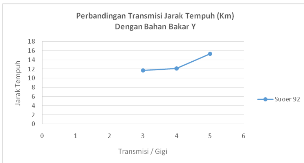
Gambar 8 Grafik Perbandingan Gigi 3,4,5 terhadap jarak Tempuh dengan bensin jenis Y
