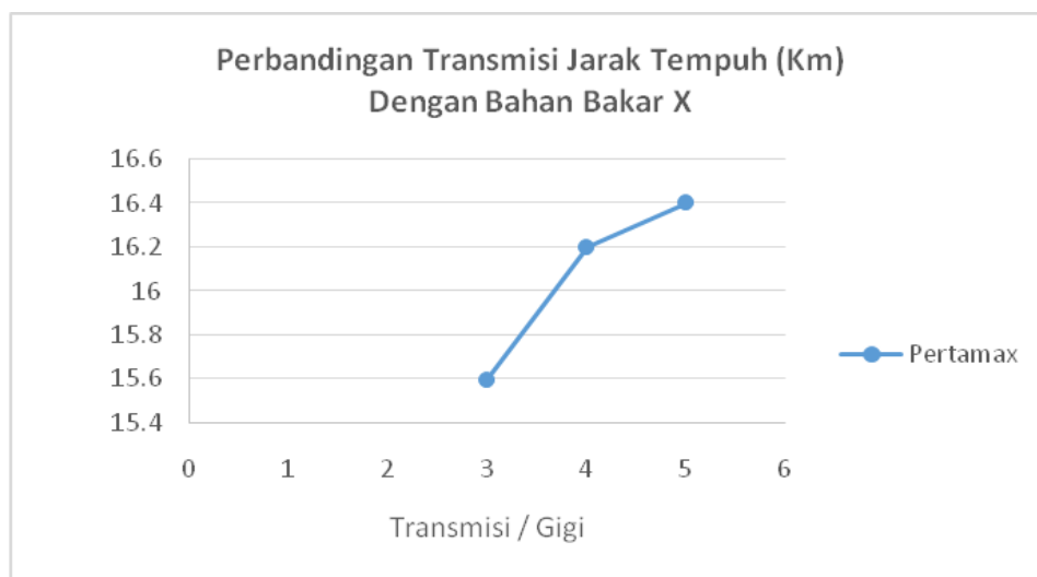
Gambar 7 Grafik Perbandingan Gigi 3,4,5 terhadap jarak Tempuh dengan bensin jenis X
