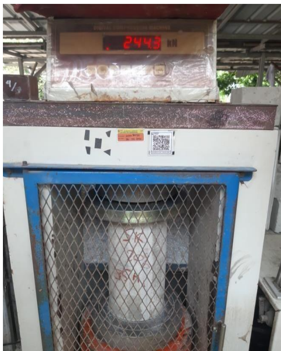
Gambar 6. Pengujian kuat tekan beton
