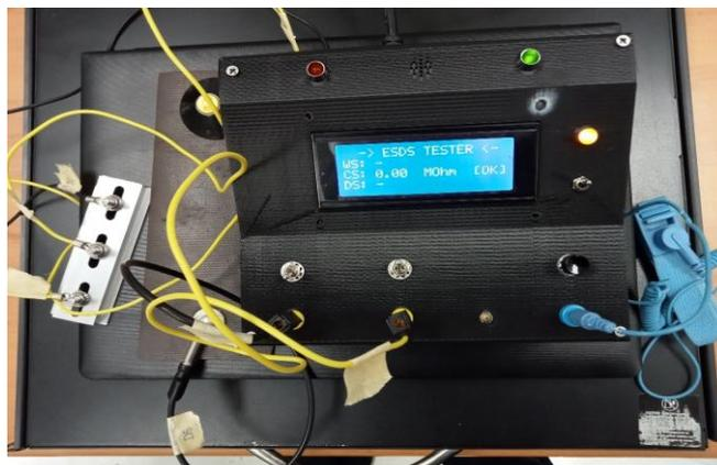
Gambar 3. Pengukuran dengan *conductive surface*
