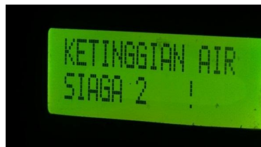
Gambar 4.4 Pengujian LCD pada siaga 2 (Sumber: dokumen pribadi)
