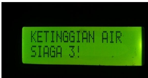
Gambar 4.2 Pengujian LCD pada siaga 3. (Sumber: dokumen pribadi)
