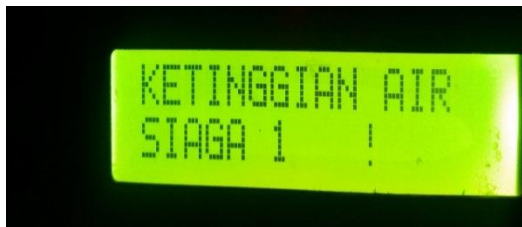
Gambar 4.6 Pengujian LCD pada siaga 1 (Sumber: dokumen pribadi)
