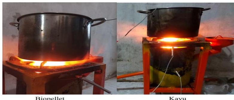
Gambar 4. Hasil Perbandingan Pembakaran Biopellet dan Kayu pada Kompor Biomassa.
