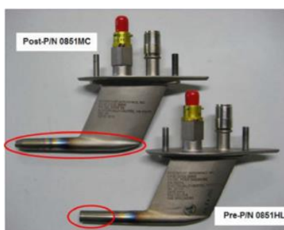
Gambar 2 Perbandingan Pitot PN 0851HL dan PN0851MC Pesawat Collins (Boeing , 2015).
