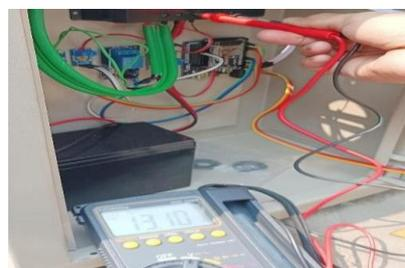
Gambar 9 Pengukuran Tegangan Panel Surya
