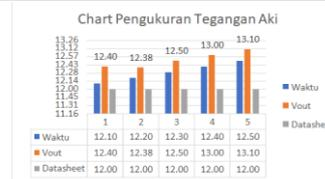
Gambar 8 Chart Pengukuran Tegangan Aki
