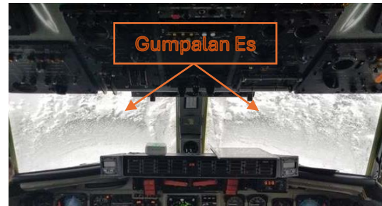
Gambar 3. Contoh terbentuknya lapisan es pada kaca ruang kemudi ( cockpit ).
