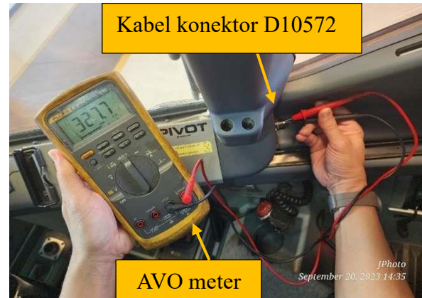
Gambar 10. Pengukuran Nilai Resistansi Sensor temperatur kaca samping kanan ruang kemudi ( cockpit ) B737-800
