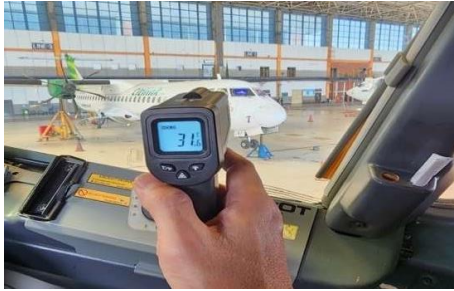
Gambar 11. Pengukuran Suhu Kaca samping ruang kemudi ( cockpit ) B737-800
