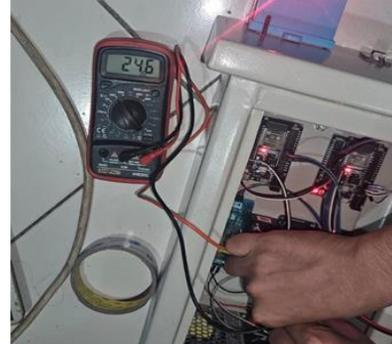
Gambar Pengukuran Tegangan pada Hi-Link Sumber : (dokumen pribadi)
