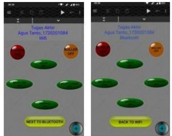
Gambar 6 Tampilan menu tombol pada HMI Modbus Android
