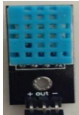
**Gambar 2. Sensor DHT11**
