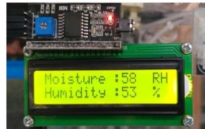
**Gambar 10. Pembacaan Nilai Kelembaban Tanah pada LCD**
