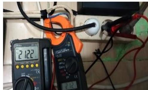
Gambar 5. Hasil ukur tegangan menggunakan Multimeter dan Clamp Meter.
