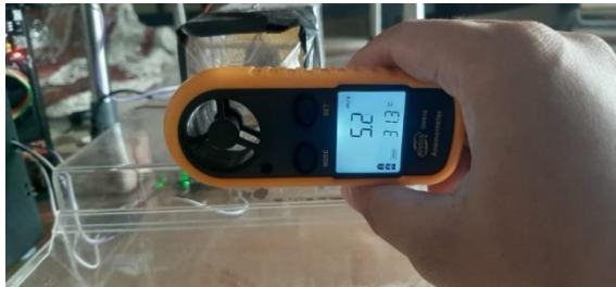
Gambar 6 pengujian daya hisap
