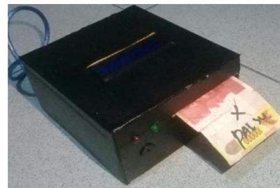
Gambar 5. Proses pengujian uang menggunakan alat pendeteksi uang palsu
