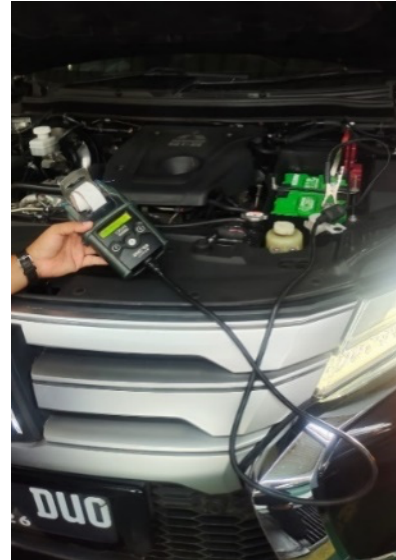
Gambar 3. Pemeriksaan tegangan Accu
