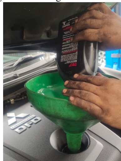
Gambar 7. Pergantian Oli Mesin
