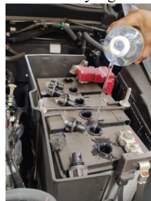
Gambar 11. Penambahan Air Accu
