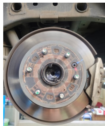
Gambar 4. Pemeriksaaan ketebalan Kampas Rem dan Disk Brake
