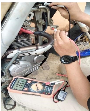
Gambar 4. pengujian tegangan puncak primer koil
