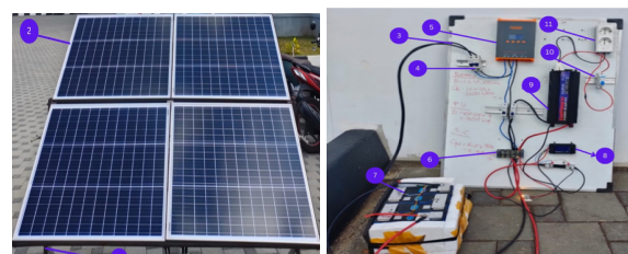
Gambar 1. Hasil rancang bangun PLTS Off Grid
