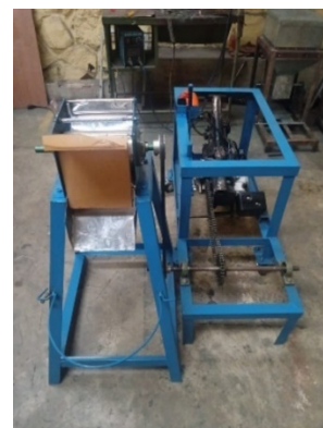
Gambar 2. Mesin pamarut kelapa menggunakan mesin Jupiter Z1 113 cc
