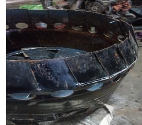
Gambar 7. Membuat Lengkungan di Atas Permukaan Drum
