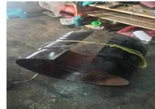
Gambar 3. Membuat Diameter Drum Yang Kecil
