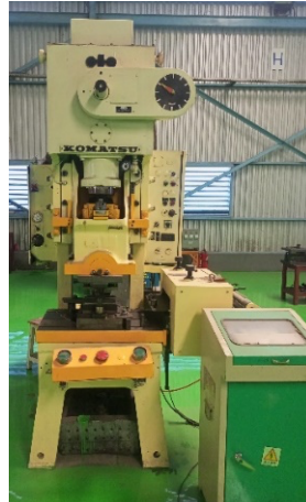
Gambar 1. Mesin pres punching pneumatik komatsu 45 Ton Adapun spesifikasi pada mesin tersebut tercantum pada Tabel 1.
