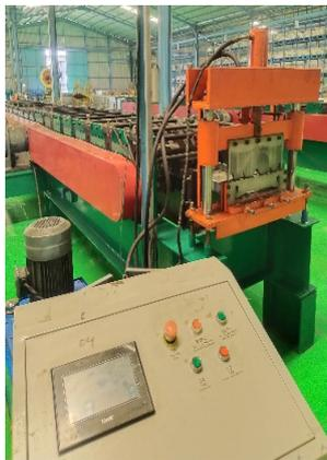
Gambar 2. Mesin *roll forming*
