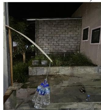
Gambar 3 Uji Pembebanan
