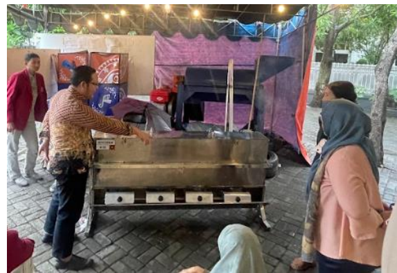
Gambar 5. Proses Pengukusan Kain Ecoprint Pada Mesin Pengukus
