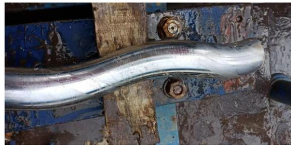
Gambar 10. Kondisi rotor yang rusak
