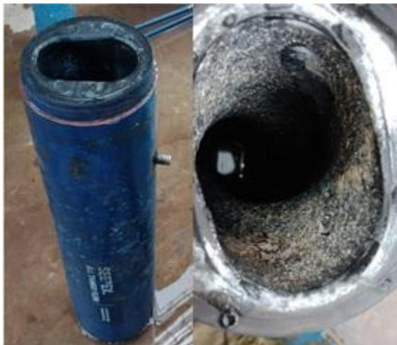
Gambar 9. Stator dan bagian yang aus
