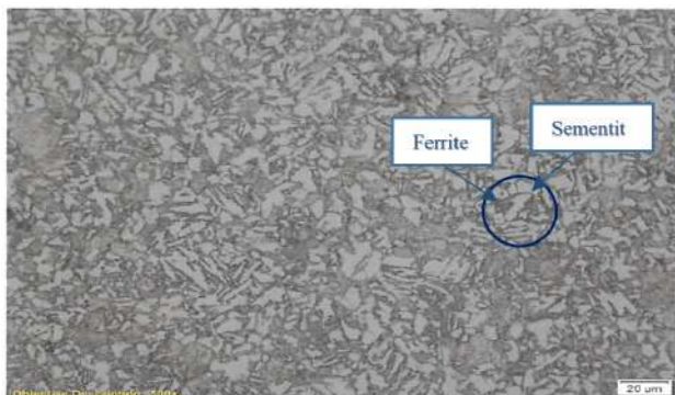
Gambar 6. Struktur mikro posisi 2 roda gigi sesudah treatment dengan proses tempering temperatur 300 °C (500x pembesaran).
