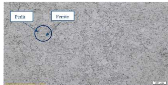
Gambar 10. Lokasi 6 pengambilan struktur mikro Sumber: Laboratorium Material Teknik B2TKS BPPT
