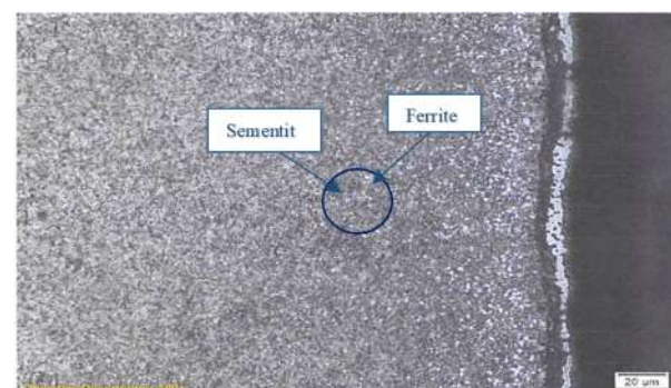
Gambar 7. Struktur mikro posisi 5 roda gigi sesudah treatment dengan proses tempering temperatur 300 °C (500x pembesaran).
