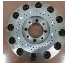
Gambar 7. Proses pengecekan kekerasan sebelum harden
