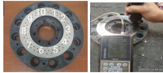
Gambar 12. Pengecekan kekerasan setelah harden
