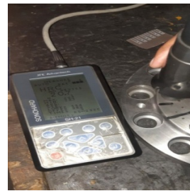
Gambar 7. Proses pengecekan kekerasan sebelum harden
