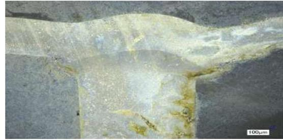
**Gambar 8** Hasil *Visual crack Welding* Kedua
