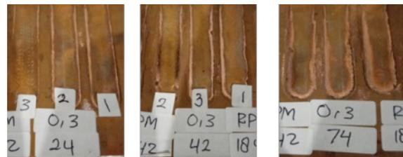
Gambar 3. Spesimen Kedalaman Pemakanan 0.3 mm.
