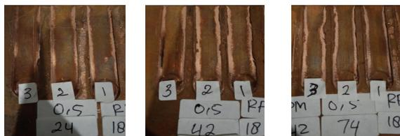
Gambar 5. Spesimen Kedalaman Pemakanan 0.3 mm.
