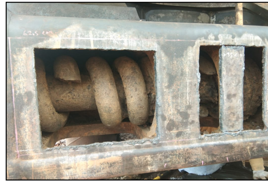
Gambar 2. Setelah side frame terpotong
