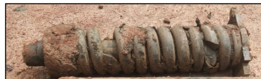
Gambar 4. Recoil spring setelah patah
