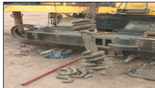
Gambar 3. Recoil spring setelah terlepas
