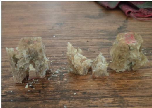
Gambar 10. Hasil pengujian tekan 80% resin, 20% komposit
