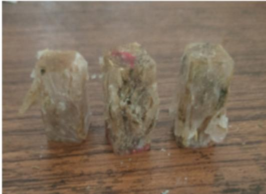
Gambar 9. Hasil pengujian tekan 70% resin, 30% komposit
