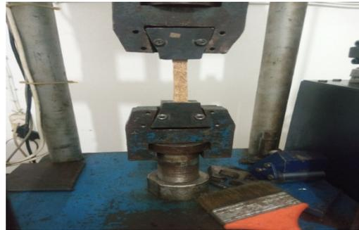
Gambar 7. Uji Tarik Spesimen sekam padi dan serat nanas
