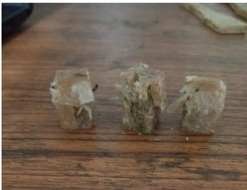
Gambar 11. Hasil Pengujian tekan 90% resin, 10% Komposit
