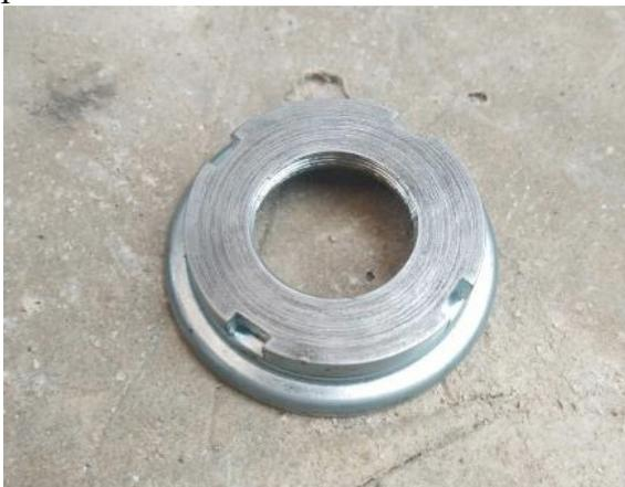
Gambar 9. Hasil pembubutan dan *milling* setelan komstir
