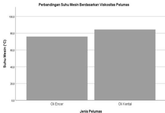
Gambar 6. Perbandingan suhu mesin berdasarkan viskositas pelumas
