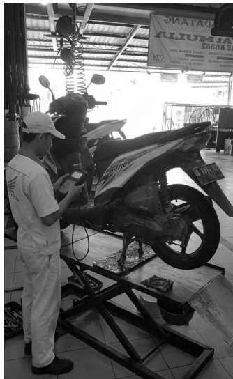
Gambar 3. Proses Pengambilan Data Temperatur Mesin pada Unit Sepeda Motor Matic.
