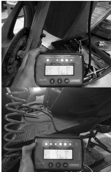
Gambar 7. Pengambilan data suhu mesin menggunakan HiDS.
