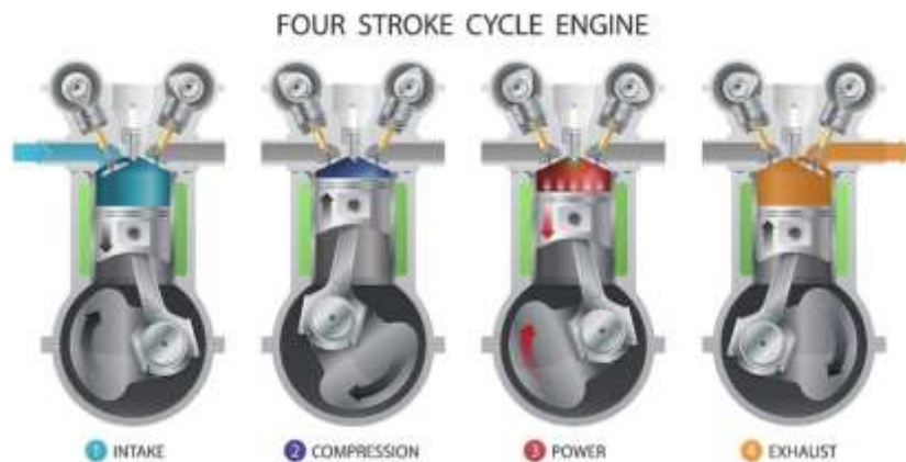
Gambar 1. Proses Pembakaran Motor Bensin
