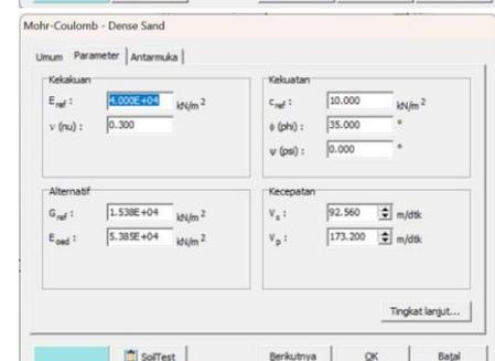
Gambar 3.8 Input parameter data tanah
