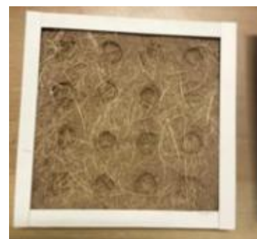
Gambar 3.1. Prototipe Panel Interior SONGGOUSTIC Berbasis Limbah Ongkok Aren Sumber: Dokumentasi Penulis (2026)
