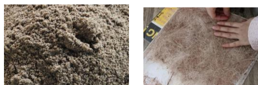
Gambar 2.1. Variasi Bentuk Material Limbah Ongkok Aren: (a) Bubuk Ongkok dan (b) Serat Ongkok
